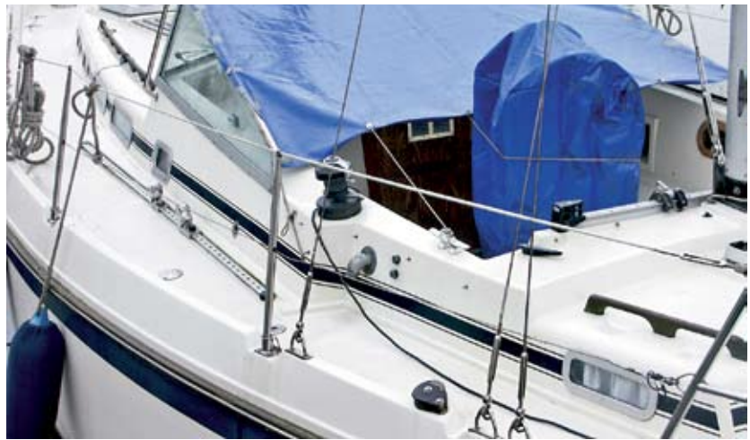
Das Cockpit bietet einer vier- bis fünfköpfigen Crew ausreichend Platz und ist gut geschützt. Die Enkes-Selftailer erleichtern die Arbeit an den Schoten erheblich, was fehlt, sind leinenverstellbare Holepunkte für die Rollgenau
