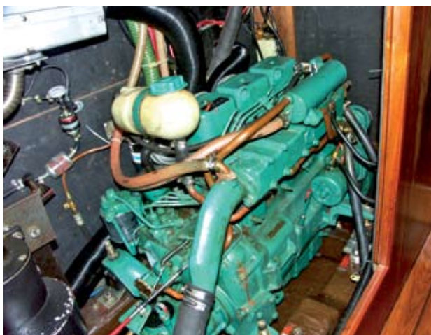
Der Volvo MD17B ist von der Seite gut zugänglich. Leider ist ein Keilriemenwechsel nur von der Stirnseite über eine zu kleine Klappe möglich
