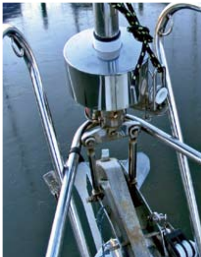
Die Lagerung des Ankers ist prinzipiell gut gelöst, leider ist dadurch die Genua sehr hoch angeschlagen
