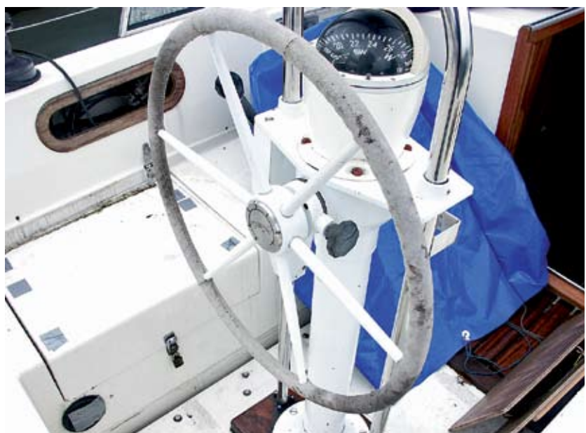
Die Ruderanlage aus dem Hause Whitlock ist eher für ein 40-Fuß-Schiff dimensioniert und arbeitet mit geringem Wartungsaufwand tadellos. Der große Nirobügel auf der Steuersäule bietet einen idealen Anschlagpunkt für Lifebelts
