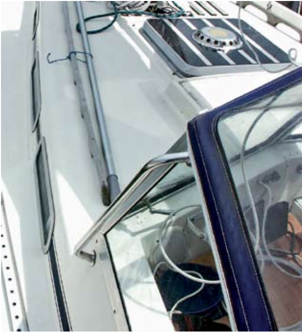
Eine große Hilfe für den Weg auf das Vorschiff sind nachgerüstete Nirobügel an der festen Scheibe, die vorher keinerlei Haltemöglichkeiten bot
