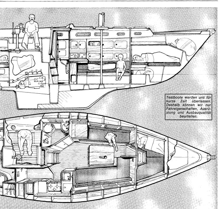
Länge über alles 9,7 m; Länge Wasserlinie 7,8 m Breite 3,32 m, Tiefgang Festkiel/Testboot 1,6 m, Tiefgang Flachkielversion 1,3 m Verdrängung 6,5 t, Ballast 2,9 t, Ballastanteil 45% Großsegel 20,9 m², Genua 36,9 m², Besan 8,0 m² Taklungsart: Ketch
